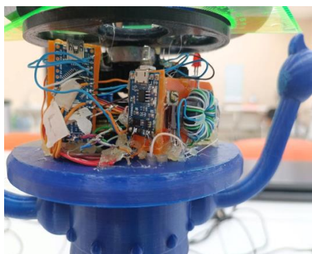
Рис.8. Подключение электроники к механизмам Результат – собранный корпус робота с установленной электроникой внутри. Срок – 30 декабря 2022г.
